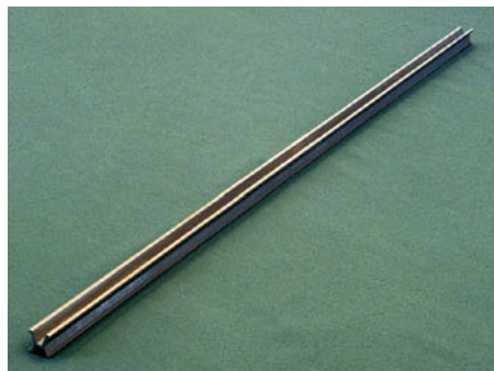
Figure 1.1 The standard platinum–iridium meter bar. (Courtesy Bureau International des Poids et Mesures, France)
